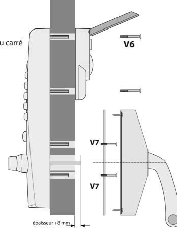
Enlever les capots et **installer l'anti-panique** sur la platine p1 coté pène en suivant les instructions fournies par le fabricant de la barre anti-panique pour la découpe et l'installation. Vérifier le niveau et installer l'anti-panique sur la platine p2 coté gond. Fixer la gâche et vérifier le bon fonctionnement avant d'installer les capots.
