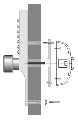
Enlever les capots et **installer l'anti-panique** sur la platine p1 coté pène en suivant les instructions fournies par le fabricant de la barre anti-panique pour la découpe et l'installation. Vérifier le niveau et installer l'anti-panique sur la platine p2 coté gond. Fixer la gâche et vérifier le bon fonctionnement avant d'installer les capots.
